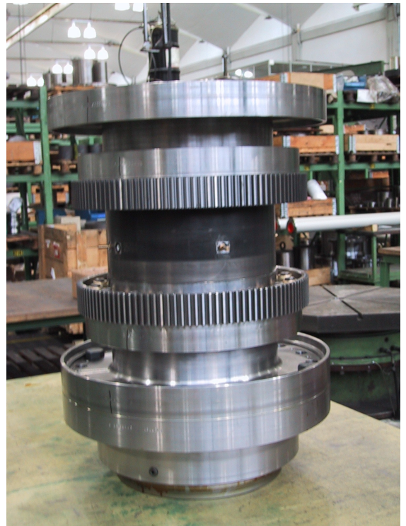
Bild 1: Hyguard® Kupplung mit Messverzahnung
